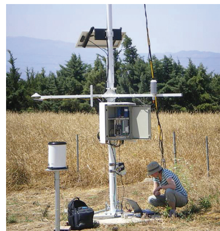
Передатчик метеоданных Vaisala WXT520 — 6 различных метеорологических измерений в одном инструменте.
