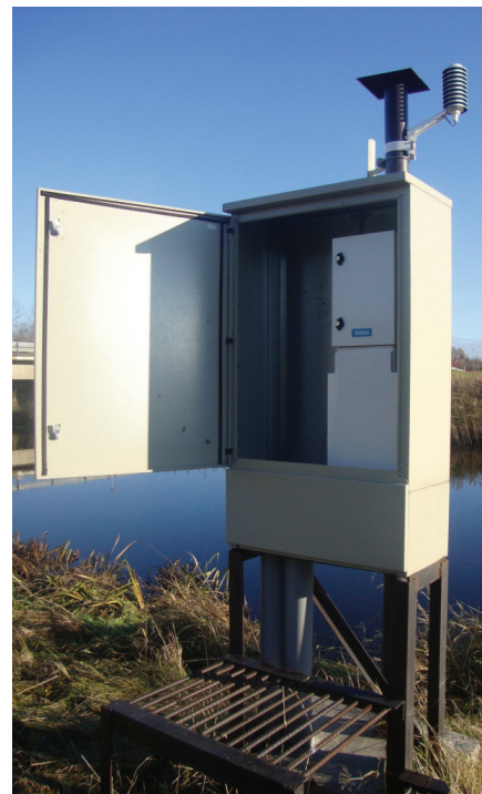
Метеорологическая станция для определения уровня воды Vaisala MAWS в Эстонии.
